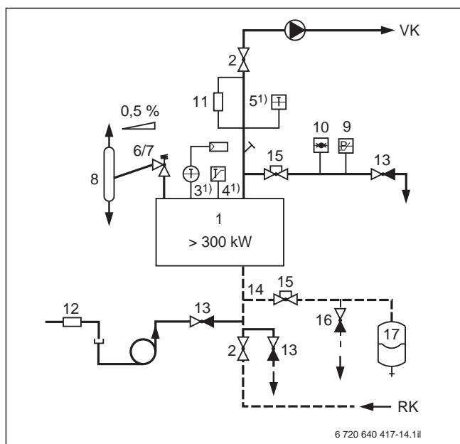
Рис. 25 Приборы безопасности по EN 12828 для котлов  $> 300 \text{ кВт}$  с предохранительным ограничителем температуры (STB)  $\leq 110^{\circ}\text{C}$
