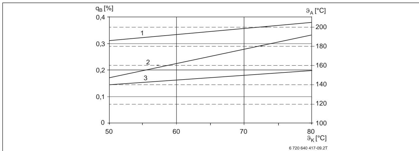
Рис. 16 Потери при эксплуатационной готовности и температура дымовых газов в зависимости от средней температуры котловой воды – Logano SK655
