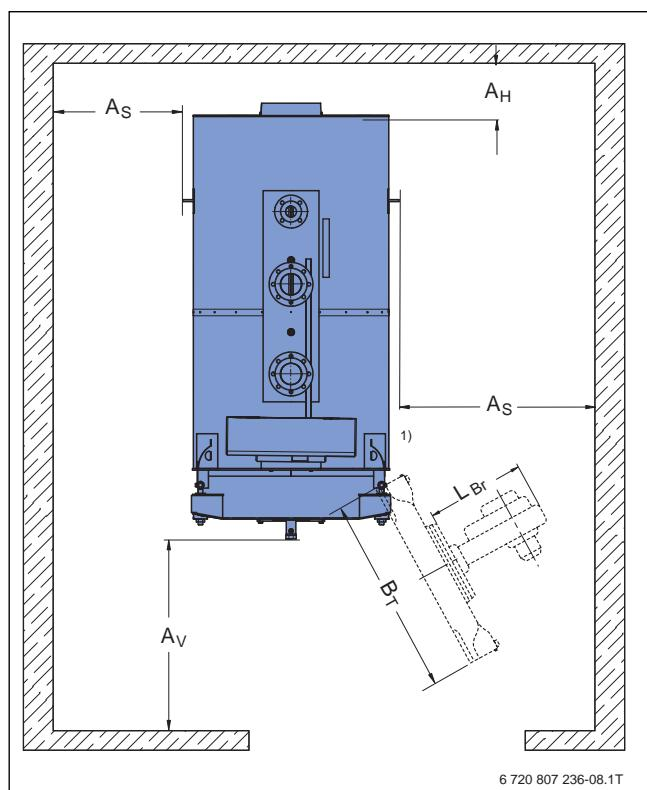
Рис. 36 Помещение с котлом Logano SK655 или SK755
