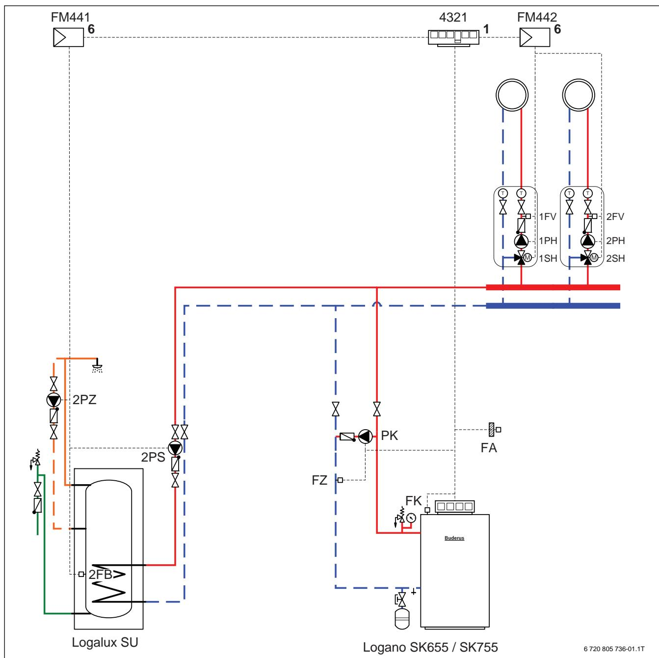
Рис. 32 Пример установки с Logano SK655 или SK755
