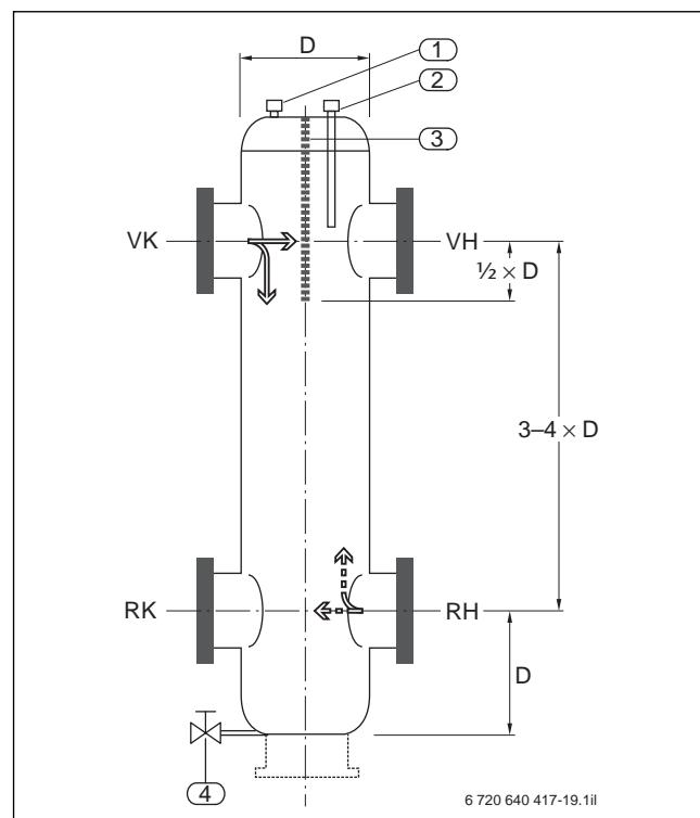
Рис. 29 Принципиальная схема гидравлической стрелки
