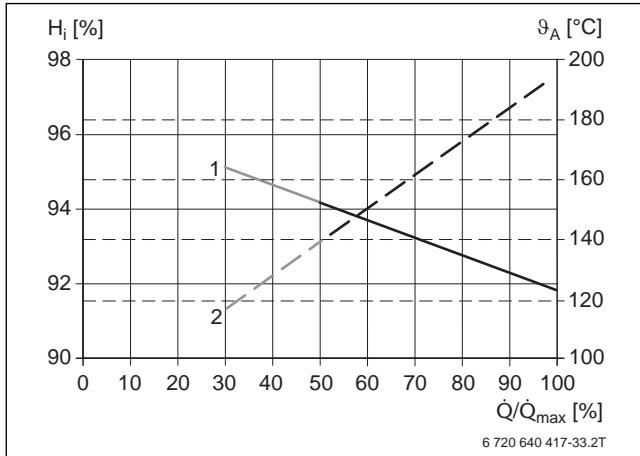
Рис. 15 КПД котла и температура дымовых газов в зависимости от нагрузки на котёл при средней температуре котловой воды 70 °C – Logano SK755
