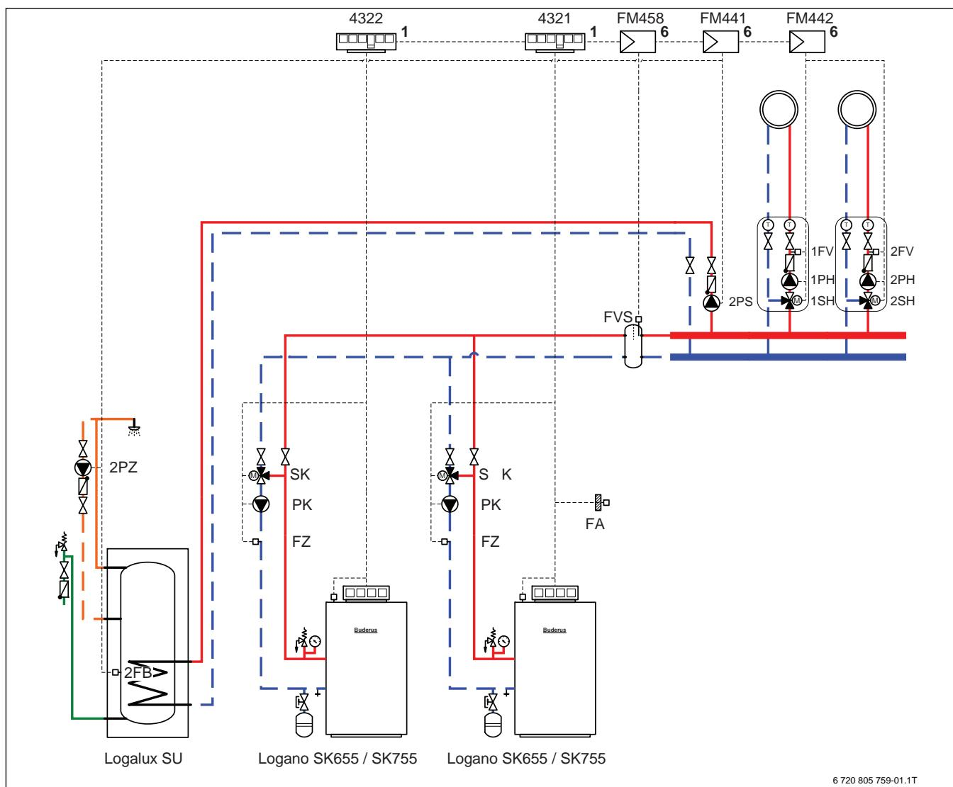
Рис. 34 Пример установки с Logano SK655 или SK755
