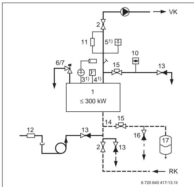
Рис. 24 Приборы безопасности по EN 12828 для котлов  $\leq 300 \text{ кВт}$  с предохранительным ограничителем температуры (STB)  $\leq 110^{\circ}\text{C}$
