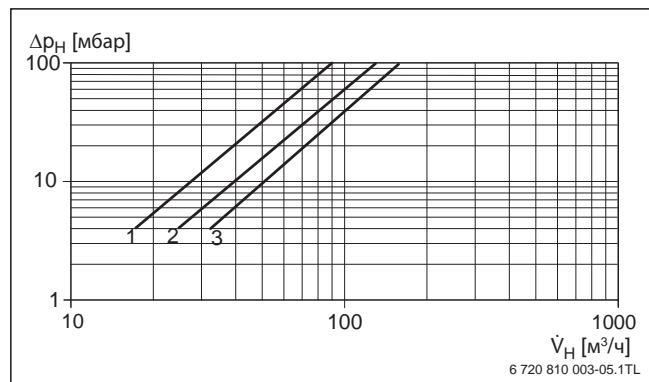
Рис. 11 Гидравлическое сопротивление водяного контура Logano SK755
