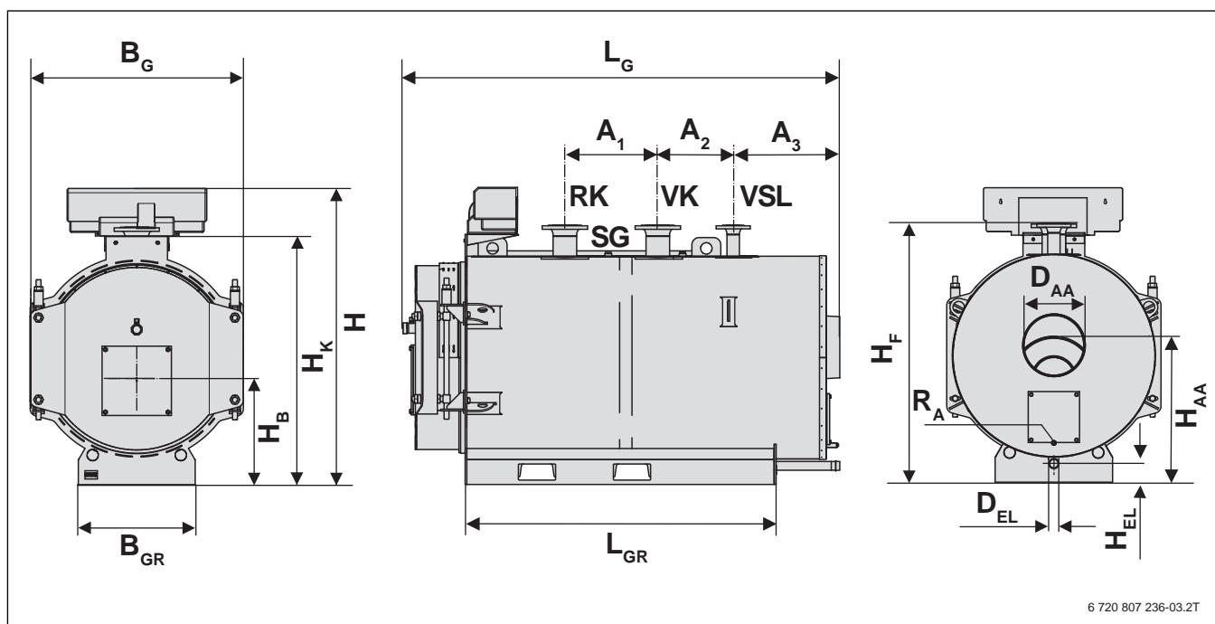
Рис. 6 Размеры Logano SK755 420 - 820 кВт
