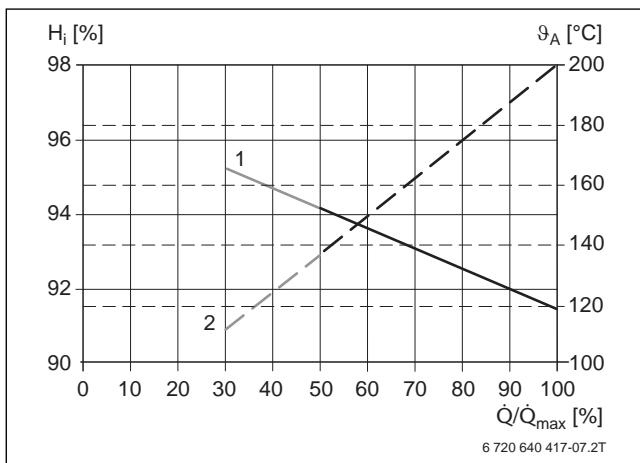
Рис. 14 КПД котла и температура дымовых газов в зависимости от нагрузки на котёл при средней температуре котловой воды 70 °C – SK655
