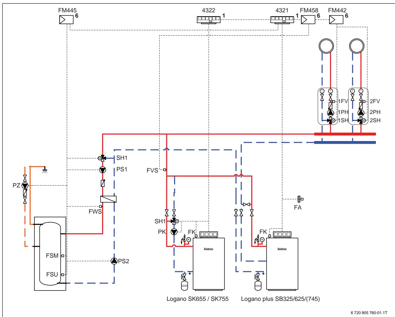
Рис. 35 Пример установки с Logano SK655 или SK755, а также Logano plus SB325, SB625 или SB745
