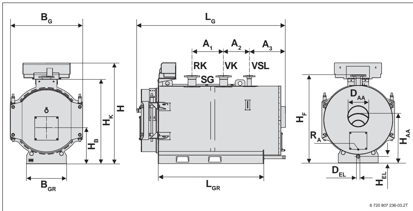
Рис. 5 Размеры Logano SK655 120 - 360 кВт
