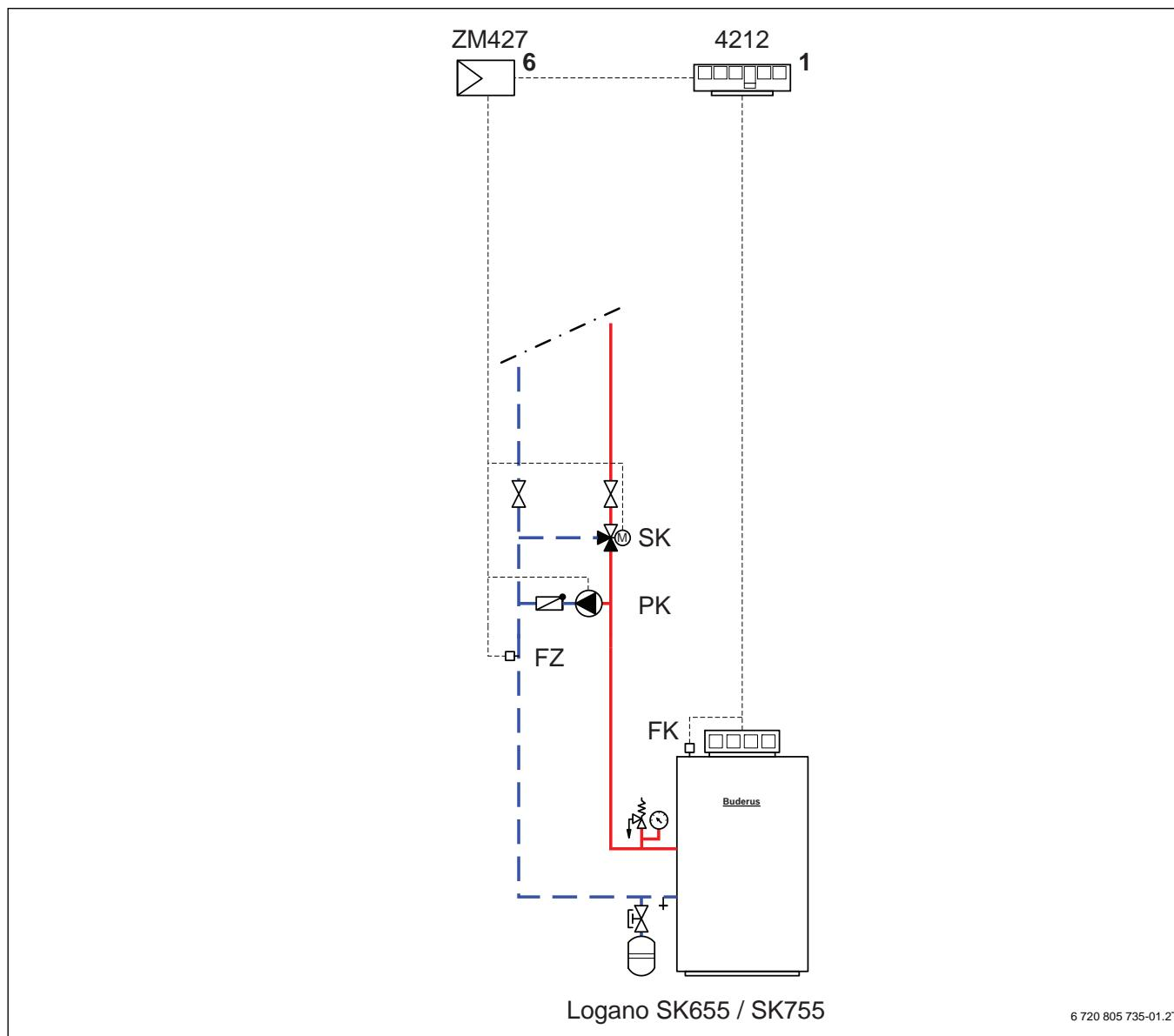
Рис. 30 Пример установки с Logano SK655 или SK755
