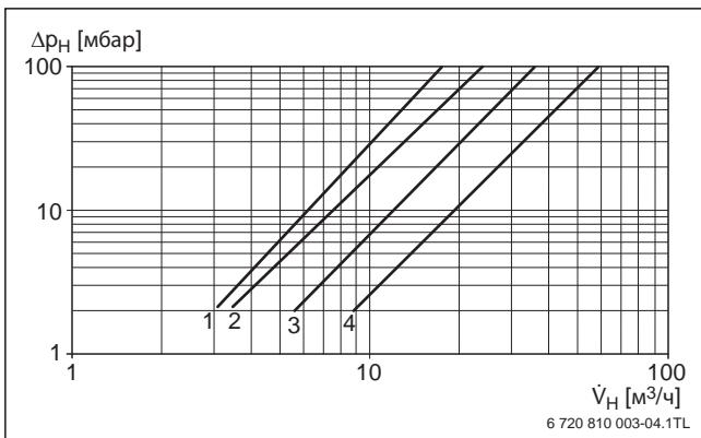
Рис. 10 Гидравлическое сопротивление водяного контура Logano SK655/SK755
