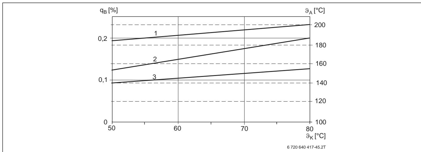
Рис. 17 Потери при эксплуатационной готовности и температура дымовых газов в зависимости от средней температуры котловой воды – Logano SK755
