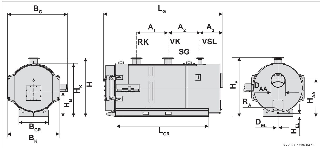
Рис. 7 Размеры Logano SK755 1040 - 1200 кВт
